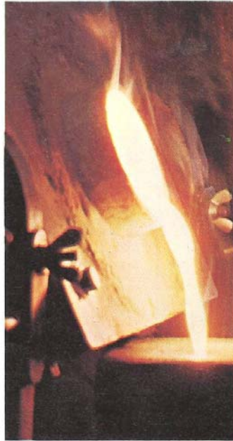
Il platino fuso viene versato negli stampi per ottenere lingotti.
